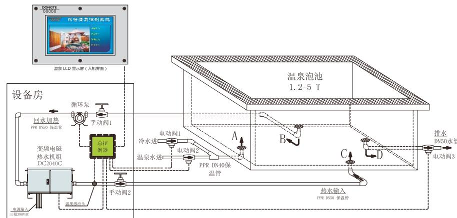
温泉恒温热水工程，可将 LCD 控制面板放置于泡池旁边，便于客户直接操作。
