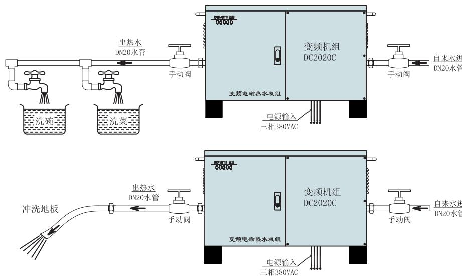
酒店、西餐厅的厨房，无需水箱，变频电磁热水机组，内部温度感应头直接检测出水温度，恒温连续输出热水给用户；可以直接用来连接厨房的洗菜，清洗盘子，或者冲洗地板。无需等待，立即供水。
