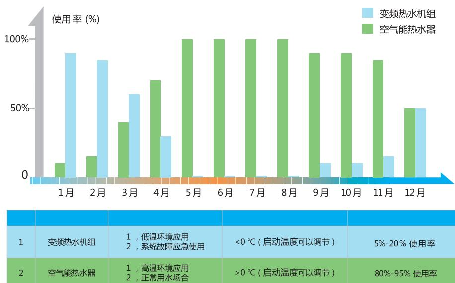
寒冷的冬季，变频热水机组与空气能热水器交替开启，确保一年 365 天足量热水供应；
